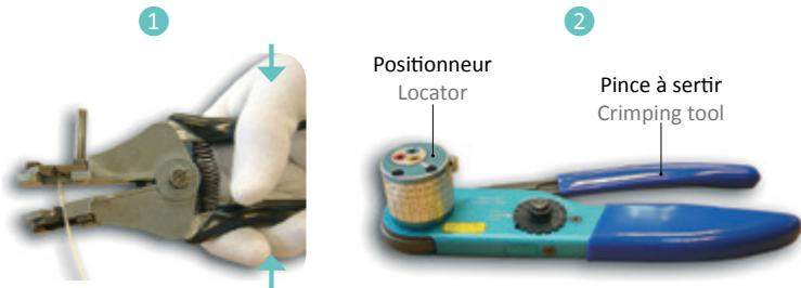
1 Les câbles doivent être dénudés au moyen d'un outil approprié pour éviter de blesser l'âme et la gaine isolante.
