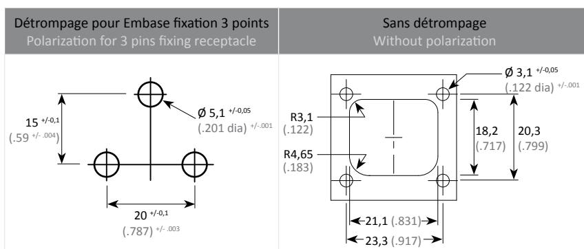
A noter : Le plan de perçage des vis de fixation sur panneau des versions A à G est identique à celui de la version «Sans détrompage» ci-dessus.
